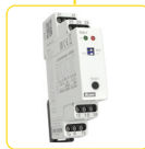
TER-7 Kontrola oteplení vinutí motoru v pásmu daném odporem zabudovaného PTC termistoru (1,8-3,3 kΩ), doplňující funkce (paměť, reset), výstupní kontakt 2x 8 A přep., napájení: AC/DC 24-240 V. str. 138
