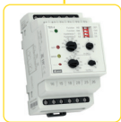
TER-4 Široký a přesný rozsah nastavení -40 .. +110 °C v 10-ti rozsazích v jednom přístroji, jemné dostavení teploty, 2 vstupy pro NTC senzor, 2 výstupy 16 A přepínací, doplňující funkce (paměť, hystereze, indikace vadného senzoru) napájení: AC/DC 24-240 V (galv. oddělené). str. 139
