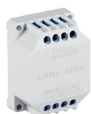
Automatické relé pro ovládání žaluzií - Napájecí napětí: 230 V - 50 Hz - Jmenovitý proud: 6 A - Elektrická blokace - Lokální žaluziové připojení Ref. 21283 Pro centralizované ovládání instalace připojení Ref. 21283 • Schéma zapojení na str. 39
