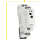
CRU1-18, CRO1-18 CRU1: hlídá pokles velikosti proudu pod nastavenou hodnotu I_{min} . CRO1: hlídá překročení velikosti proudu přes nastavenou hodnotu I_{max} . Str.: 137
